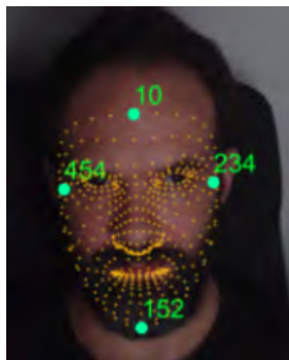
Fig. 4 - Identificação dos 4 pontos (dos providenciados pelo facetracking) utilizados para calculo da rotação de cabeça (pontos 10, 152, 234 e 454). A imagem foi capturada com a permissão explícita da pessoa retratada.
